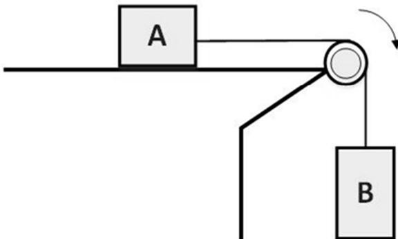
Considere o sistema de dois blocos A e B de massas  $m_A$  e  $m_B$ , com  $m_B > m_A$ , que estão ligados por uma corda de peso desprezível que passa sem atrito pela polia, conforme representado na figura. Esse sistema se desloca para a direita, e a aceleração da gravidade é dada por  $g$ . Entre o bloco A e a superfície de apoio, existe atrito de coeficiente  $\mu$ .
