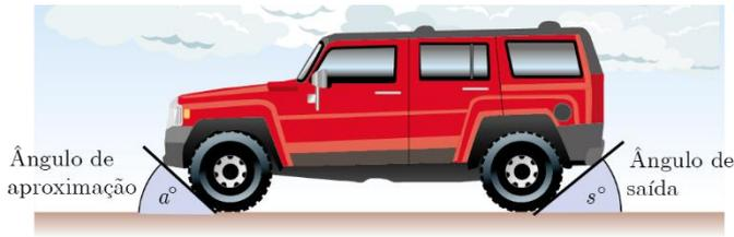
No projeto de um veículo *off-road* são definidos o ângulo de aproximação ( $a$ ), que indica o quão íngreme é a inclinação que um veículo pode subir sem danificar o para-choque dianteiro, e o ângulo de saída ( $s$ ), que indica a capacidade de um veículo de sair de uma inclinação sem danificar o para-choque traseiro.
