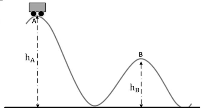
Nessa figura, um carro de montanha-russa, de massa  $m$ , chega ao ponto A com velocidade  $v_A$ . Supondo-se o atrito desprezível, assinale a alternativa que expressa corretamente a velocidade do carro no ponto B, considerando  $g$  a aceleração da gravidade e  $h_B = \frac{h_A}{2}$ .
